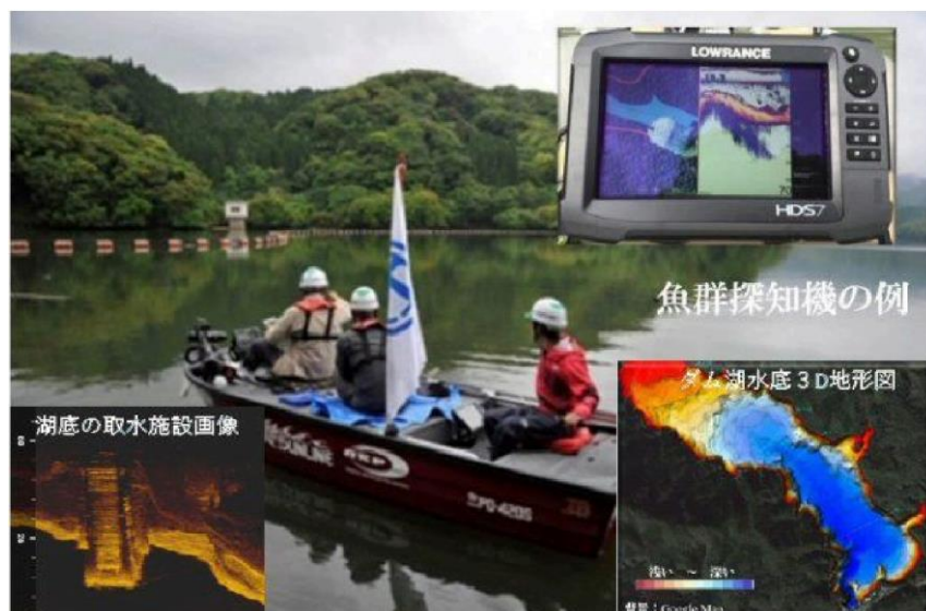
図 5.21 魚群探知機を用いた堆砂測量の実施例
