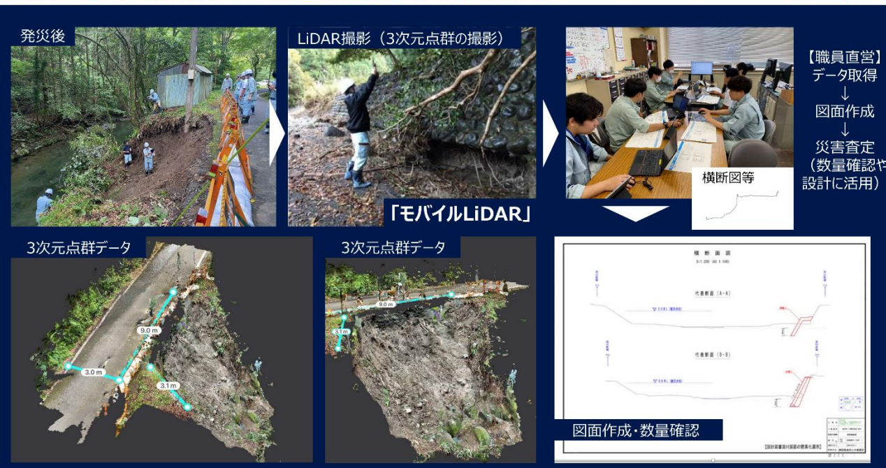
図 5.18 災害時の測量と査定図面の作成例
